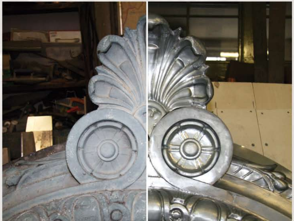
Detaillierter Vergleich: Ein neues Sporer-Ornament neben dem mehrfach lackierten Original. Stumpf gelötete Nahtstellen werden ausnahmslos mit Nahtstreifen hinterlegt
