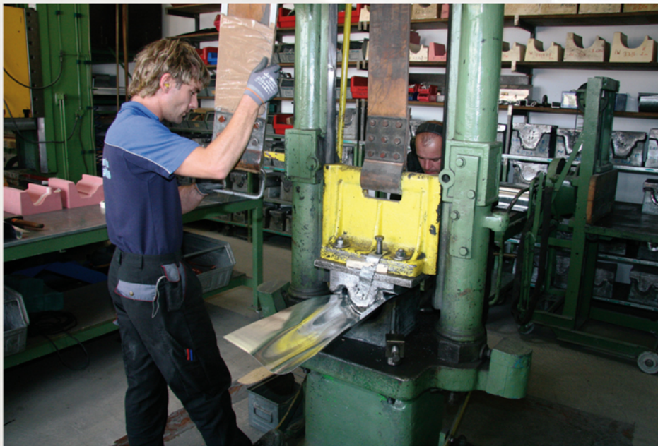
Thomas Mitter und Rainer Hummel kennen den Gießerei- und Stanzbereich der Kaufmann-Ornamentenabteilung in- und auswendig. Am „Ulmer Fallwerk“ fertigen sie unterschiedlichste Profile
