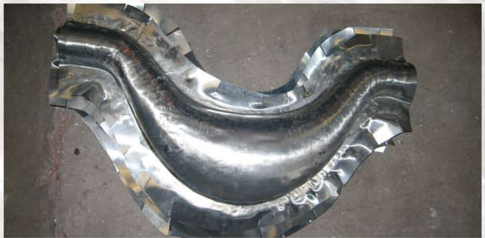
Form und Titanzink-Grundkörper der neuen noch ungeschmückten Girlanden
