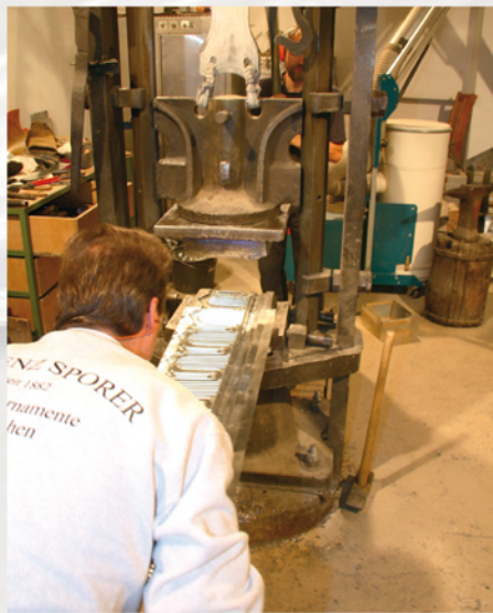
Rhythmisch stampfend donnert das schwere Gewicht des Fallwerkes auf das Zink-Werkstückes nieder. Fallwerke werden vor allem zur Herstellung von Profilen mit variablen Radien eingesetzt
